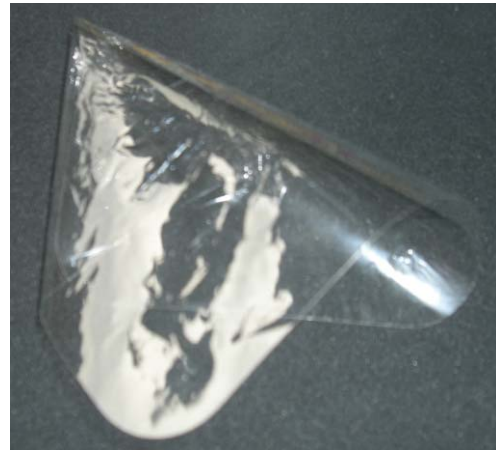
Abbildung 9: Selbstabbauende Antiadhäsionsfolie aus PLA für die Chirurgie (SurgiWrap); Dicke 0.02 mm
