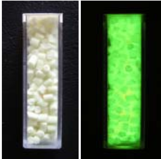
Abbildung 4: Cuvetten mit phosphoreszierendem Material Storelite® (von Tritec Ltd.) ; links: bei Tageslicht, rechts: in der Dunkelheit.
