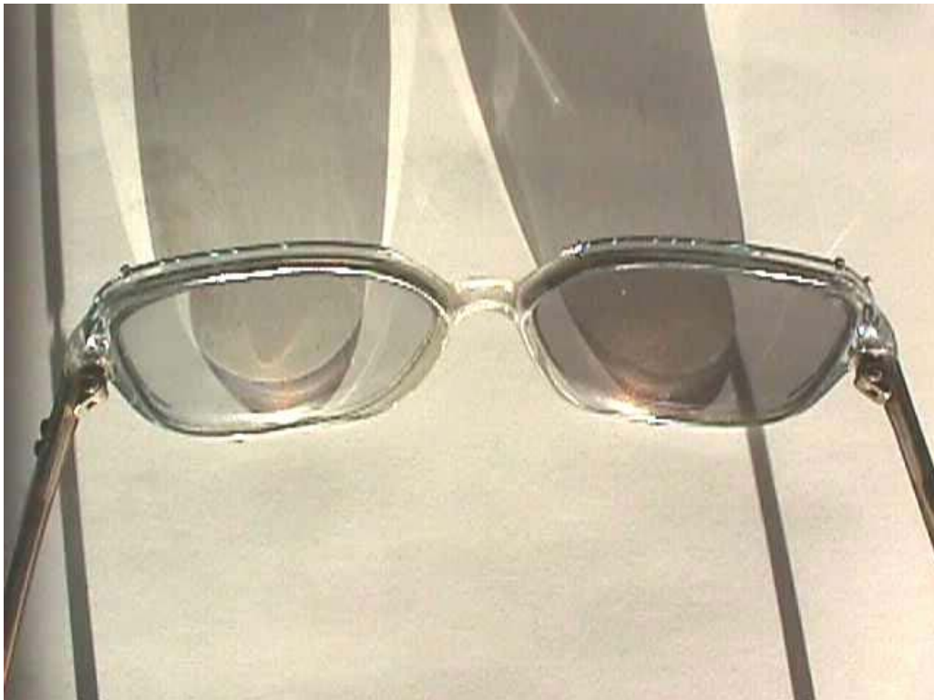
Abbildung 1: Brille mit phototropen Gläsern, das rechte Glas wurde mit UV-Licht bestrahlt
