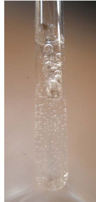
Abbildung 3: Auch in reinem Wasser bildet sich an blanker Magnesiumoberfläche Wasserstoff
